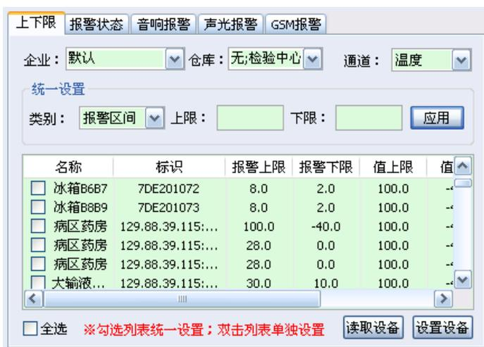
**读取设备：**将读取硬件中的报警上下限，并设置到软件中已选设备的报警上下限中（※不支持 GPRS 设备）
